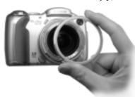
Aボタンを押しながら化粧リングを矢印の方向に回し、取り外します。
